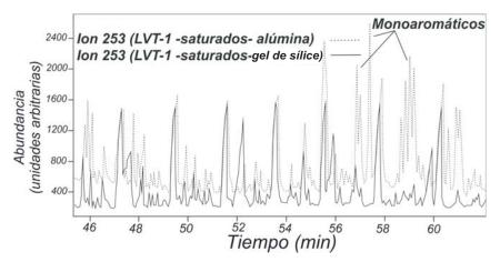
Figura 3. Fragmentogramas del ion 253 (monoaromáticos) de la fracción saturados del crudo LVT-1 con los arreglos 1 y 2.
