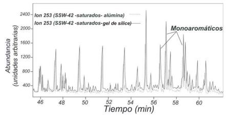
Figura 4. Fragmentogramas del ion 253 (monoaromáticos) de la fracción saturados del crudo SSW-42 con los arreglos 1 y 2.
