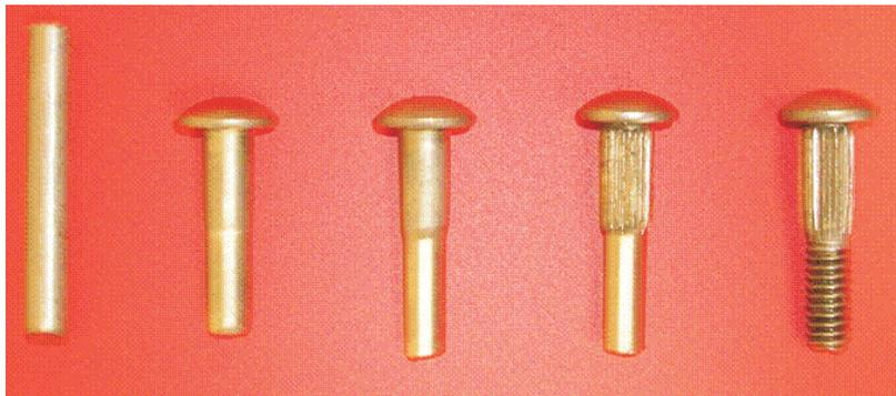
Figura 3. Resultado de la conformación en frío de birlos de acero inoxidable tipo 304.
