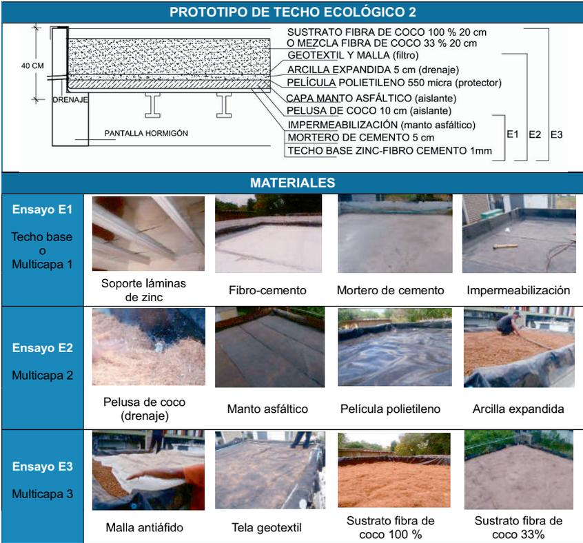
FIGURA 3. Configuración de prototipo de techo ecológico 2
