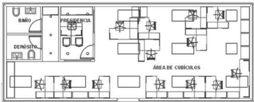
FIGURA 2. Planta distribución espacios y luminarias en el módulo de control
