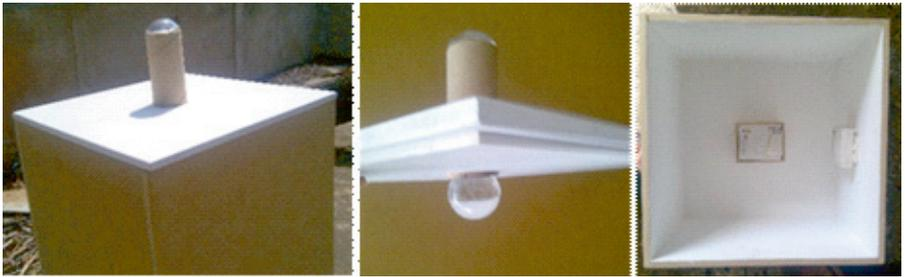
FIGURA 3. Ubicación del Componente de Conducción de Luz Natural evaluado y ubicación de dataloggers en el interior del modelo
