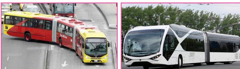
**Imágenes 5 y 6:** El primer autobús (BRT) se mueve a gasoil en calzada exclusiva, el segundo (trolebús) con electricidad, con capacidades y calidad de servicio similar. Producen similar imagen del transporte, en la medida que tengan buen mantenimiento y similar protocolo operativo.
