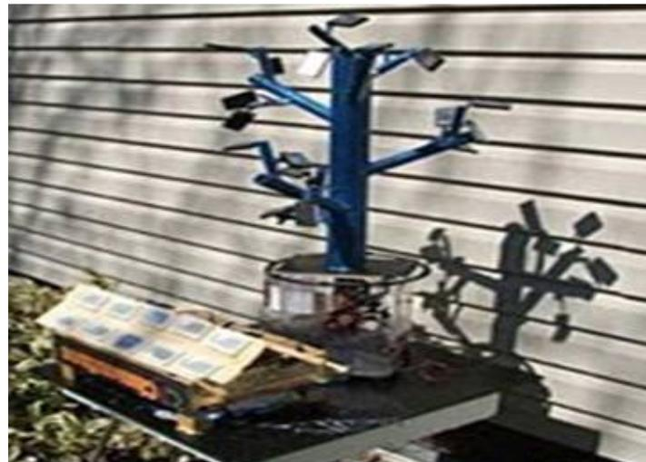
Gráfica 6. Distribución de celdas solares con sucesión de Fibonacci y de forma fija
