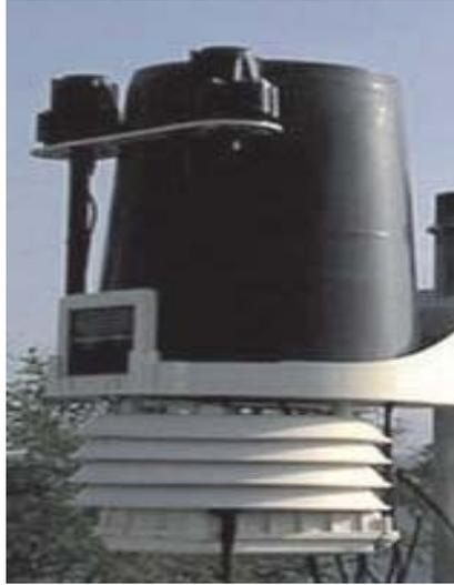
**Imagen 3. Pluviómetro y sensores de radiación incorporados.**
