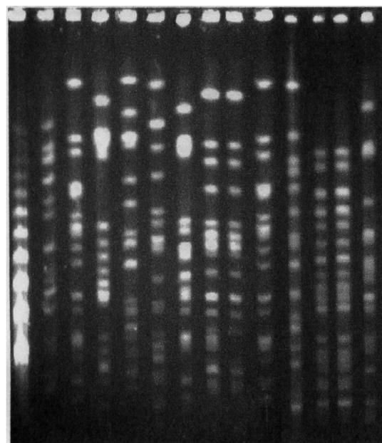
**Figura 2.** Electroforesis de campo pulsado de las cepas de *K. pneumoniae*, en el carril 1 marcador de peso molecular, carriles 2 – 14 muestras aisladas de pacientes, al igual que en *E. coli* se observa un alto grado de policlonalidad, pero los aislados ubicados en los carriles 8 y 9 poseen un alto grado de similitud, al igual que los ubicados en los carriles 12 y 13.
