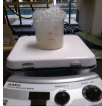
Desmineralización del sólido con 60 mL de HCl 1,25 N
