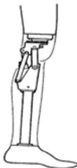
**Figura 1.** Prótesis para Desarticulación de Rodilla Kutz (2009)
