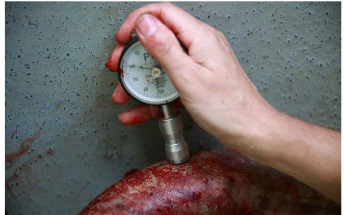
FIGURA 5: Midiendo la dureza superficial en la pala
