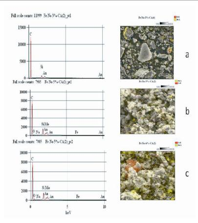
Figura 4. Micofotografias SEM y análisis EDS para las muestras FeMo (II)/C 3%(a), FeMo (II)/C 5% (b) y FeMo (II)/C 6% (c).
