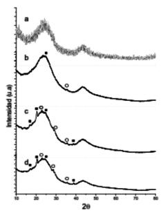
Figura 3. Patrones de DRX de las muestras Carbón activo soporte (a), FeMo (II)/C 3% (b), FeMo (II)/C 5% (c), FeMo (II)/C 6% (d); (O)  $\beta$ -FeMoO4, ( $\blacksquare$ )  $\alpha$ -FeMoO4.
