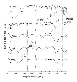
Figura 1. Espectros FT-IR de los catalizadores FeMo (II) másico (a), FeMo (II) 3%/ C (b), FeMo (II) 5%/C (c), FeMo (II) 6%/C (d), carbón activo soporte (e).
