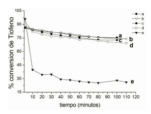
Figura 5. Actividad catalítica en HDS de tiofeno para las muestras preparadas FeMo (II)5%/C (a), FeMo (II)3%/C (b), FeMo (II)6%/C (c), FeMo(II) (d), FeMo(III,II) (e)
