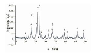
Figura 2. Patrón de DRX para el FeMo(II) másico, calcinado a 500°C; (o)  $\beta$ -F-eMoO<sub>4</sub>, ( $\blacksquare$ )  $\alpha$ -FeMoO<sub>4</sub>, Fe(MoO<sub>4</sub>)<sub>3</sub> ( $\Delta$ ), MoO<sub>3</sub>( $\Diamond$ ).
